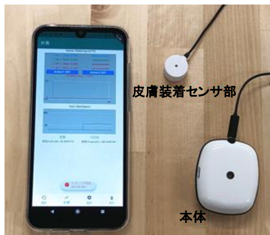
図 15 ウェアラブル発汗センサ SKW-1000 の外観写真(右)と Android アプリ(左)
