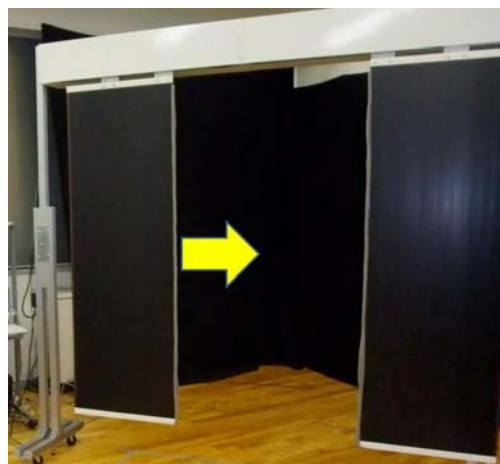
写真3: 隙間通過行動を測定するための可変式ドア
